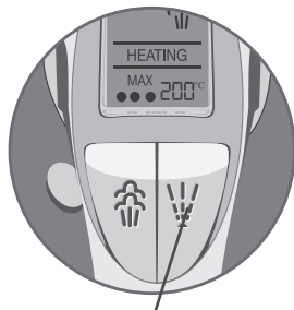
Commande du Jet de Vapeur Froide
